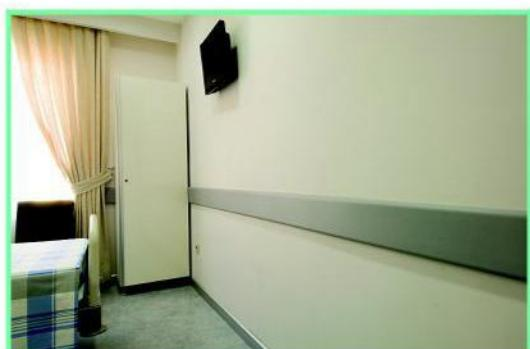
WG100 - отбойная доска шириной 100 мм., толщиной 20 мм.. Она монтируется на стену при помощи сплошного алюминиевого профиля и глушил удары благодаря резиновой прокладке. Алюминиевый профиль и дополнительные элементы (заглушки, переходники и т.д.) декорированы виниловым покрытием и могут быть одного цвета. Она монтируется на стену при помощи фиксирующих элементов с интервалом 50-60 см. Длина профиля – 4 метра, и производится в 12 различных цветах.
