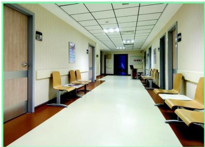
WG200 – отбойная доска шириной 200 мм., толщиной 35 мм., монтируется на стену сплошным алюминиевым профилем и резиновой вставкой. Выпускается разных цветов и устанавливается на стены различными крепежными элементами на расстоянии 50-60 см. в соответствии с покрытием стены. Длина элемента 4 метра.
