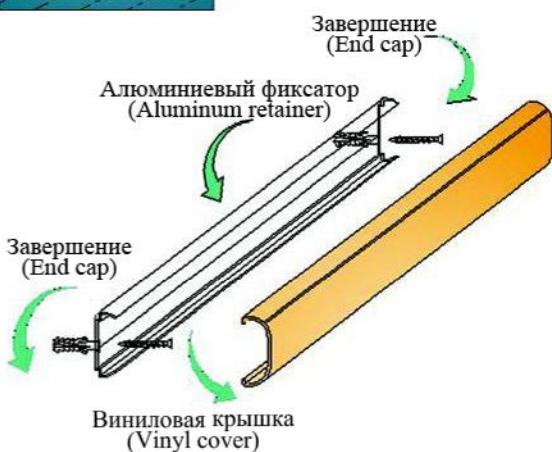
CR50 – отбойник от стульев шириной 50 мм и толщиной 20 мм, монтируется на стену сплошным алюминиевым профилем, выдерживающие удары. Имеет декоративное виниловое покрытие, выдерживающее царапины. Алюминиевый профиль и дополнительные элементы (заглушки, переходники и т.д.) декорированы виниловым покрытием и могут быть одного цвета. Его длина – 4 метра, производится в 12 разных цветах.
